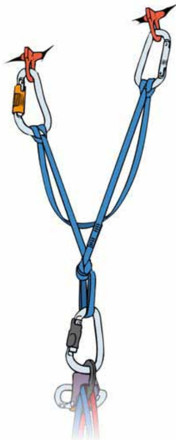
Fig. 3: Parada Sequencial equalizada.
