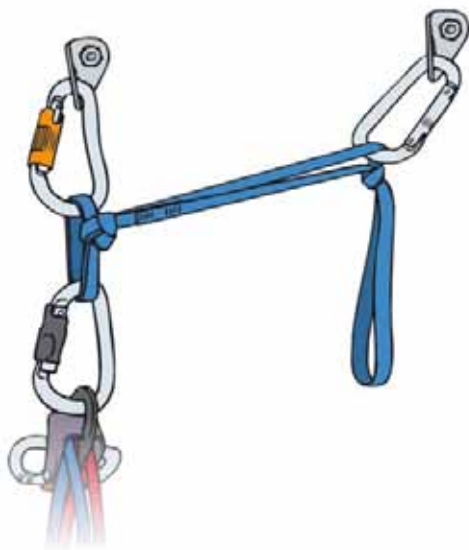
Fig. 2: Parada Sequencial com fita – ideal para guia único.
